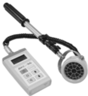
Блок детектирования бета-излучения на основе счетчика Бета-2
